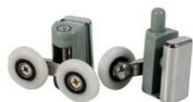
P/N : MS-1007 滑轮 \phi 22-27mm 方向: 摆动 玻璃厚度: 5-6mm 材质: 尼龙 玻璃开孔: \phi 12mm
