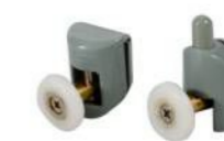
P/N : MS-1004 滑轮 \phi 22-27mm 方向：摆动 玻璃厚度：4-6mm 材质：尼龙、铜轴 玻璃开孔： \phi 10mm
