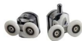
P/N : MS-1010 滑轮 \phi 22-27mm 方向: 摆动 玻璃厚度: 5-8mm 材质: ABS 玻璃开孔: \phi 12mm
