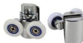
P/N : MS-1008 滑轮 \phi 22-27mm 方向: 摆动 玻璃厚度: 5-8mm 材质: 锌合金 玻璃开孔: \phi 12mm
