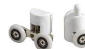
P/N : MS-1005 滑轮 \phi 22-27mm 方向：摆动 玻璃厚度：4-6mm 材质：尼龙 玻璃开孔： \phi 10mm
