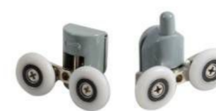
P/N : MS-1002 滑轮 \phi 22-27mm 方向：摆动 玻璃厚度：4-6mm 材质：尼龙 玻璃开孔： \phi 10mm
