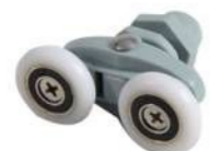
P/N : MS-1011 滑轮 \phi 22-27mm 方向: 摆动 玻璃厚度: 4-6mm 材质: ABS 玻璃开孔: \phi 12mm
