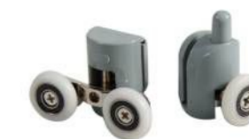
P/N : MS-1001 滑轮 \phi 22-27mm 方向：摆动 玻璃厚度：4-6mm 材质：尼龙 玻璃开孔： \phi 10mm
