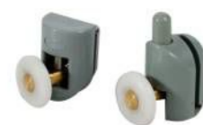
P/N : MS-1006 滑轮 \phi 22-27mm 方向: 摆动 玻璃厚度: 4-6mm 材质: 尼龙、连体铜轴 玻璃开孔: \phi 10mm
